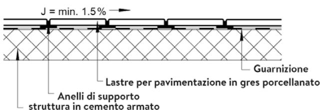
Immagine 11: Realizzazione del rivestimento della lastra su una struttura rigida in calcestruzzo. Se posate su anelli in gomma i giunti non devono essere sigillati.
