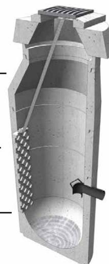
Sezione schematica dell'uscita per anfibì AMFIX® installata in un tombino stradale
