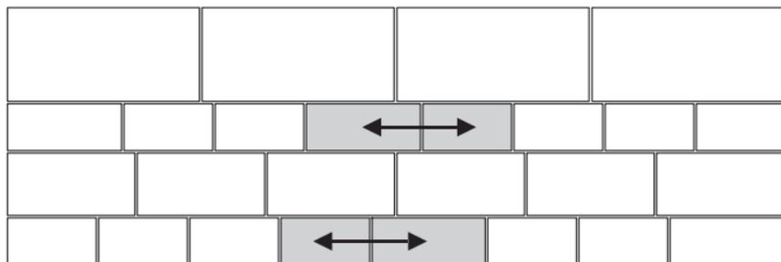
Sostituire le pietre ogni 2 file, evitare di posare giunti incrociati.
