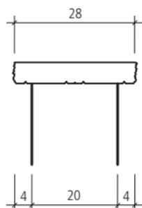
lastra di copertura per muro
