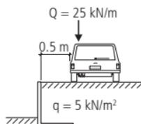
**Carico tipo G2 (autocarro  $> 3.5$  to, SN 671 256a)**
