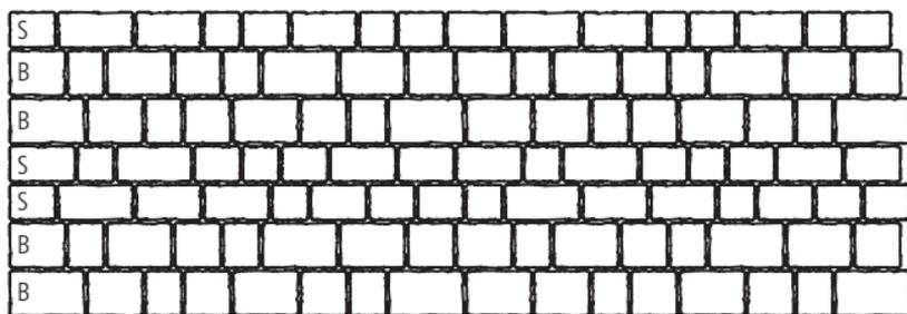
Per ottenere una superficie con un aspetto omogeneo consigliamo la seguente variante di posa.
