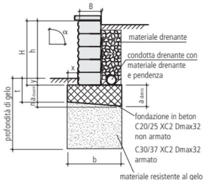
**riempimento orizzontale per costruzione muro inclinato**
