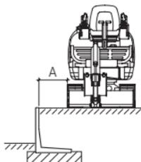
La distanza minima da rispettare per il transito di piccoli escavatori (peso < 3.5 ton) è di 0.80 m. Per escavatori più pesanti, la distanza minima è da aumentare in maniera adeguata.
