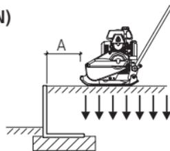
**Carico tipo F2 compressione (peso  $\leq 100$  kg, RK  $\leq 12$  kN)**
