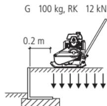
Secondo il tipo di carico e riempimento, la misura di distanza minima può essere discussa con il nostro personale tecnico. La distanza minima da rispettare per transito di auto/autocarri da delimitare sul posto.
