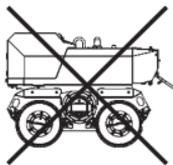
apparecchi pesanti per il compattamento non sono ammessi
