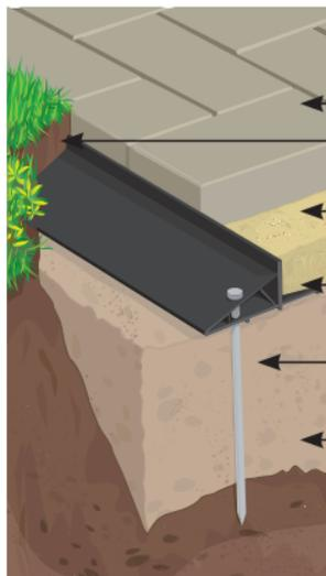
Il fissaggio avviene sullo strato di fondazione (bauletto di fondazione)
