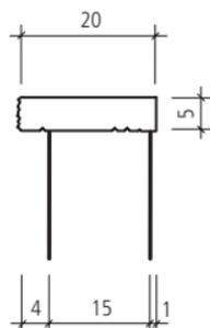
lastra di copertura per muro
