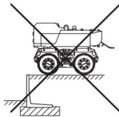
La distanza minima da rispettare per il transito di piccoli escavatori (peso 3.5 ton) è di 0.80 m. Per escavatori più pesanti, la distanza minima è da aumentare in maniera adeguata.
