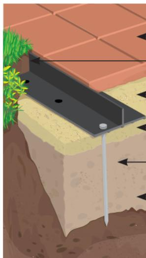
Il fissaggio avviene sullo strato di fondazione (miscela sabbia/splitt)
