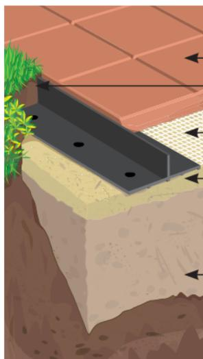
Il fissaggio del cordolo PAVE EDGE® sul letto di posa, avviene tramite la posa delle lastre direttamente sulla rete saldata al cordolo.
