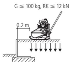
Secondo il tipo di carico e riempimento, la misura di distanza minima può essere discussa con il nostro personale tecnico. La distanza minima da rispettare per transito di auto / autocarri da delimitare sul posto.
