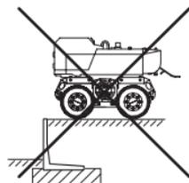
La distanza minima da rispettare per il transito di piccoli escavatori (peso 3.5 ton) è di 0.80 m. Per escavatori più pesanti, la distanza minima è da aumentare in maniera adeguata.
