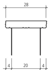
lastra di copertura per muro
