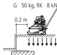
Secondo il tipo di carico e riempimento, la misura di distanza minima può essere discussa con il nostro personale tecnico. La distanza minima da rispettare per transito di auto / autocarri da delimitare sul posto.
