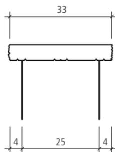
lastra di copertura per muro
