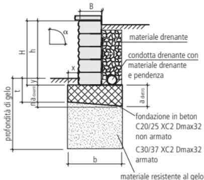
**riempimento orizzontale per costruzione muro inclinato**
