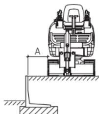
La distanza minima da rispettare per il transito di piccoli escavatori (peso  $\leq 3.5 \text{ ton}$ ) è di 0.80 m. Per escavatori più pesanti, la distanza minima è da aumentare in maniera adeguata.
