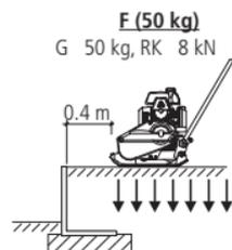
Secondo il tipo di carico e riempimento, la misura di distanza minima può essere discussa con il nostro personale tecnico. La distanza minima da rispettare per transito di auto / autocarri da delimitare sul posto.
