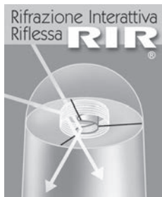
captazione e ridirezionamento della luce solare diretta e diffusa con il sistema Rifrazione Interattiva Riflessa – RIR®
